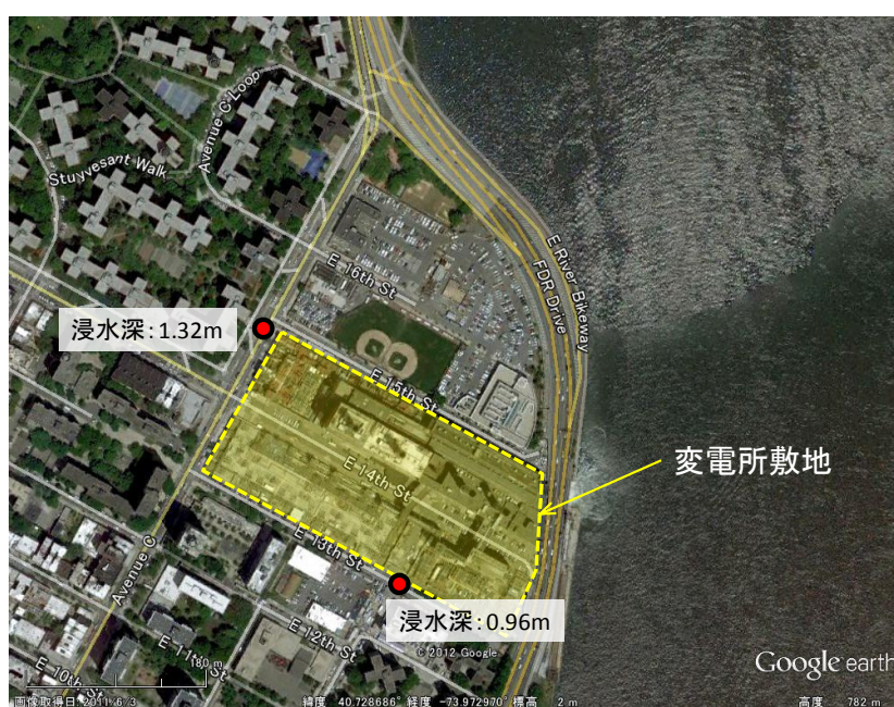
図-3 変電所周辺（Google Earth に加筆）
