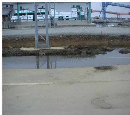
図5. 砂地盤の液状化
